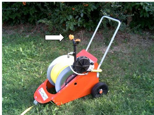
**9.** L'angolazione dei fori di uscita dell'IRRIGATORE 360° incide sulla superficie irrigata. Posizionando orizzontalmente i fori si ottiene la massima superficie irrigata.
