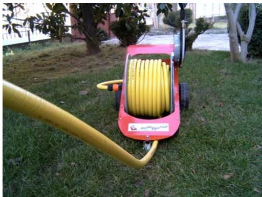
**3.** Stendere il tubo. Lasciare almeno una spira di tubo completa avvolta sulla macchina.
