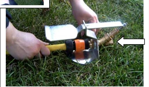
**7.** Esercitare una pressione nell'asta del dispositivo di arresto (accessorio) per permettere successivamente il passaggio dell'acqua. Collegare il dispositivo (o il tubo del Passeggiando) alla mandata dell' acqua.
