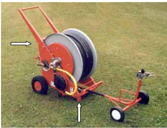
**1.** Posizionare la macchina nella posizione desiderata frontalmente l'area che si vuole irrigare. Assicurarsi che le staffe di ancoraggio del telaio siano piantate fermamente al terreno.
