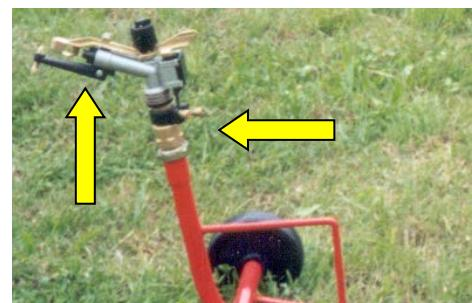
**12.** Durante l'irrigazione è possibile regolare l'intensità di pioggia utilizzando la valvola by-pass. Chiudendo la valvola la velocità di riavvolgimento del tubo aumenta, aprendo la valvola, la velocità diminuisce.
