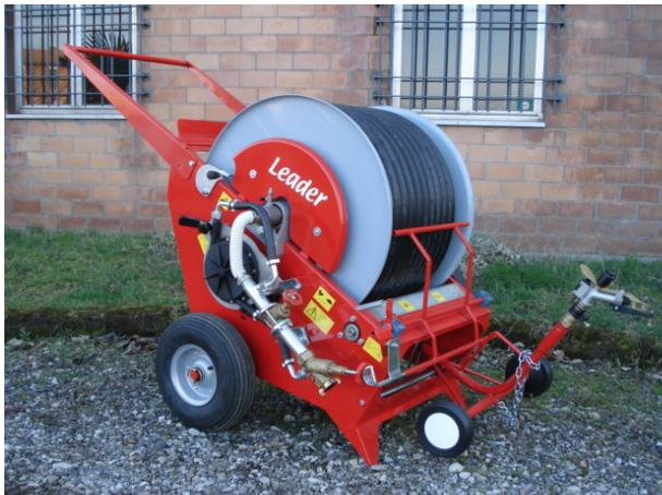
**1.** Posizionare la macchina frontalmente all'area che si vuole irrigare. Assicurarsi che le staffe di ancoraggio del telaio siano fissate fermamente al terreno.
