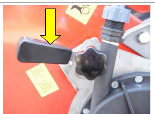
**8.** Mettere la turbina nella posizione iniziale. Allentare il pomello posto sulla turbina e spostare la leva della turbina verso il basso. Bloccare nuovamente il pomello.
