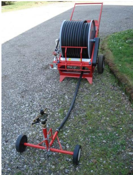
**5.** Stendere il tubo in polietilene perpendicolarmente alla macchina procedendo a bassa velocità. Utilizzare la catena di traino del carrello. Lasciare almeno una spira di tubo completa avvolta sulla macchina.
