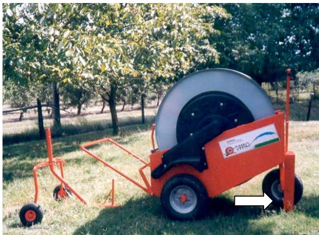
**1.** Posizionare la macchina nella posizione desiderata frontalmente l'area che si vuole irrigare. Assicurarsi che le staffe di ancoraggio del telaio siano piantate fermamente al terreno.
