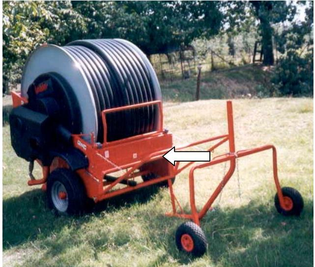
**8.** Durante l'irrigazione il Leader 50 riavvolge completamente il tubo. Il contatto con il carrello portairrigatore provoca la fine dell'irrigazione. ATTENZIONE: la macchina termina l'irrigazione ma non arresta la pompa!
